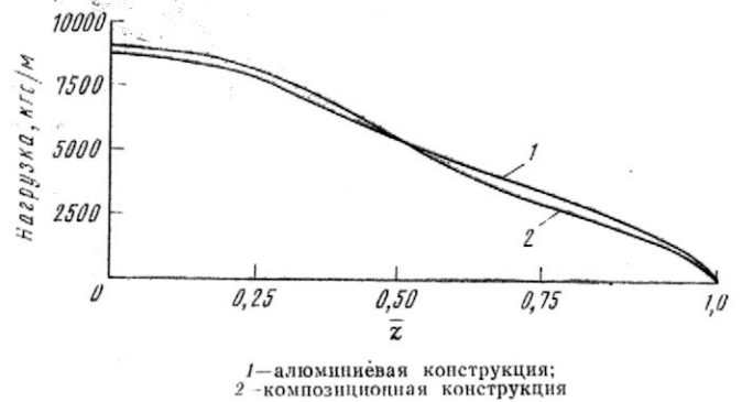
Рис. 10. Распределение аэродинамической нагрузки по размаху крыла административного самолета (прямая стреловидность, \chi = 14,5^\circ )
