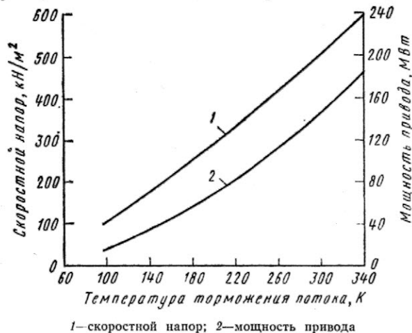
Рис. 10. Зависимость скоростного напора и мощности привода трубы от температуры рабочего газа ( Re_{\text{в.л.}} = 50 \cdot 10^6 , размеры рабочей части 2,5 \times 2,5 м)
