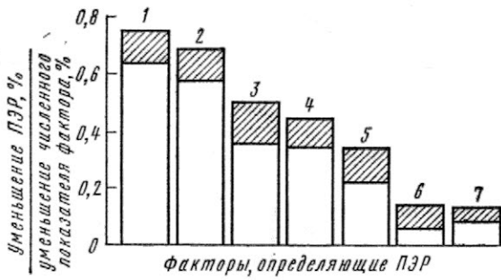
1—лобовое сопротивление; 2—продолжительность рейса; 3—вес; 4—удельный расход топлива; 5—стоимость самолета; 6—техническое обслуживание двигателей; 7—техническое обслуживание планера
